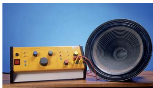
Сигнал - генератор производи тонове са различитом фреквенцијом.
