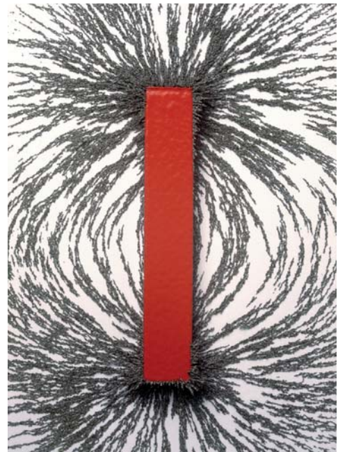
Железните струготине показуваат дека магнетното поле е појачо кај половите.
