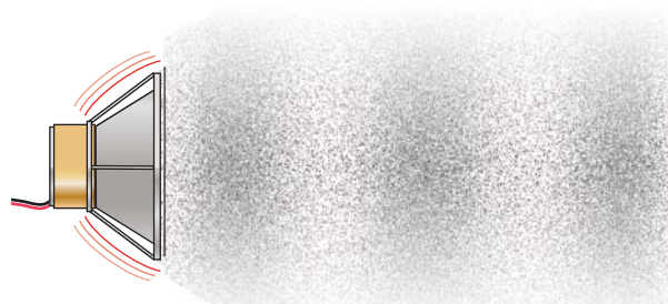
Осцилације мембране звучника стварају звучни талас који се шири кроз ваздух.
